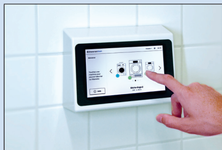
Les locataires s'identifient avec un code personnel et sélectionnent les appareils.
